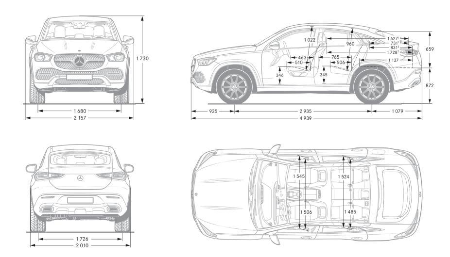
¹ Jusqu'à la jointure de la plage arrière. ² Sous la plage arrière. Cotes exprimées en millimètres. Les valeurs moyennes indiquées s'entendent pour le véhicule à vide en version de base.
